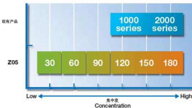
在切割加工中，集中度会影响磨粒层的消耗速度（使用寿命）及工件的加工质量（崩缺-chipping尺寸），运用高精度集中度控制技术能够使切割刀片消耗量及工件加工质量更趋向稳定。
