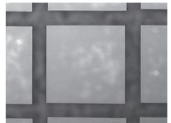
SEMx100 进刀速度：150mm/s 晶圆厚度：80μm
